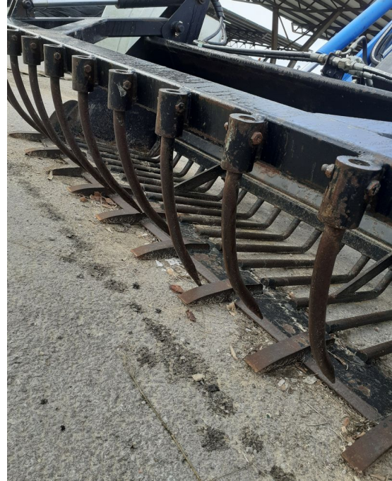
Detall de les pinces tipus palla
